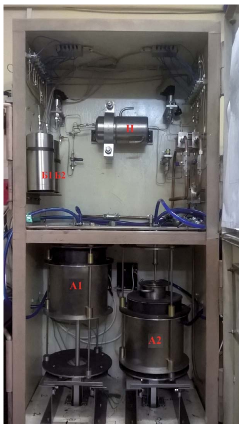
Рис. 1. Термогазобарическая установка для гидрирования и азотирования
